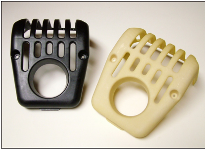
Hitzeblech und Konzeptmodell (mit ZPrinter 310 Plus gefertigt)
