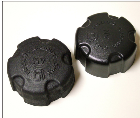
Tankkappe und Prototyp (mit ZPrinter 310 Plus gedruckt)
