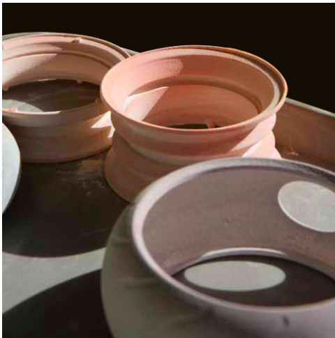
Reifen und Felgen für ein 1:5-Automodell
