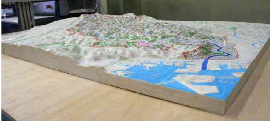
神奈川県内を流れる河川の流域を立体化した模型教材の例。地形の凹凸を緩やかに調整しており、ビー玉を転がして分水嶺などの地形の特徴を理解できるように作られている
