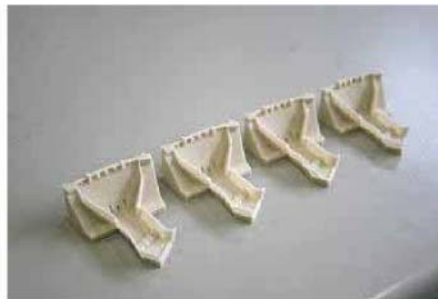
橋梁やダムなどの構造物も3Dプリンタで作れる。いろいろな構造物の形状を比較検討することができるのも模型ならではの強みだ
