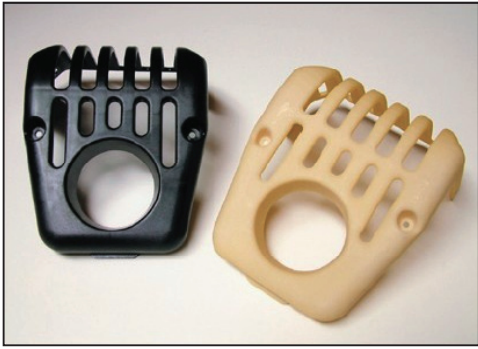
머플러 가드와 ZPrinter 310 Plus로 출력한 컨셉 모델
