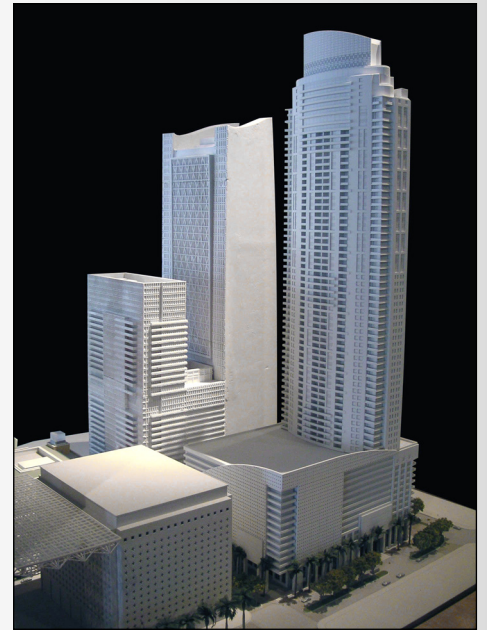
Realization Group a utilisé la ZPrinter 310 Plus pour créer ce modèle de 71 centimètres de « The Met » à Miami, moyennant un quart du temps et du coût associés aux méthodes de modélisation architecturale classiques.
