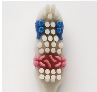
L'impression en 3D à haute définition reproduit avec précision les soies des brosses à dents
